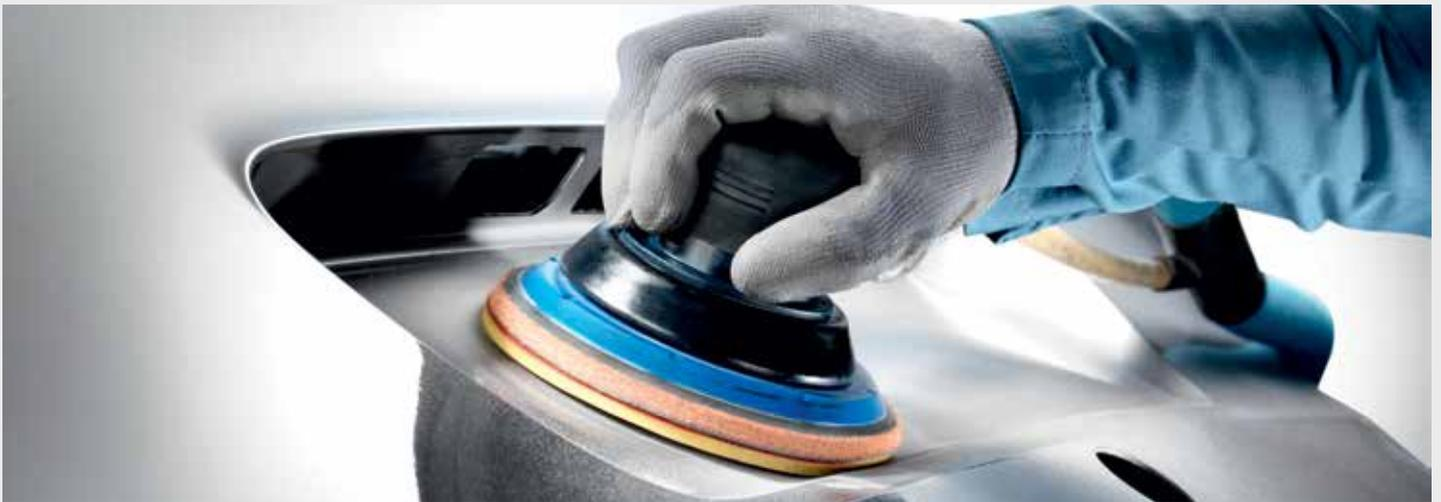
**Utilisations sur ponceuse orbitale pour le ponçage des formes et contours**
