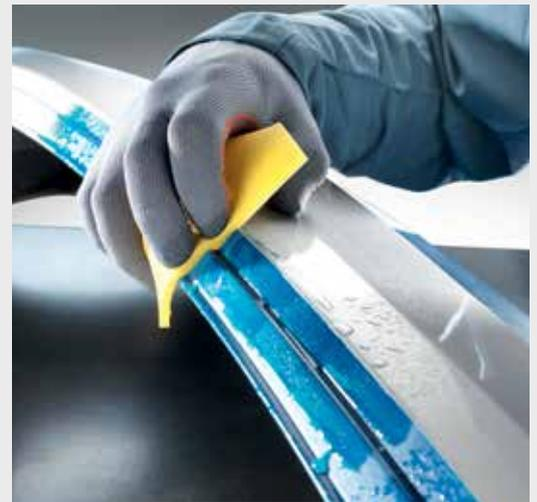
**Ponçage manuel des contours et arêtes**
