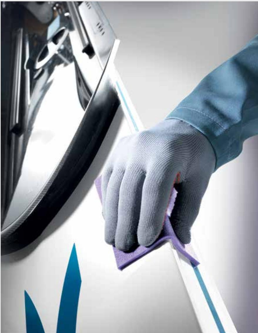
**Ponçage manuel des contours et arêtes**
